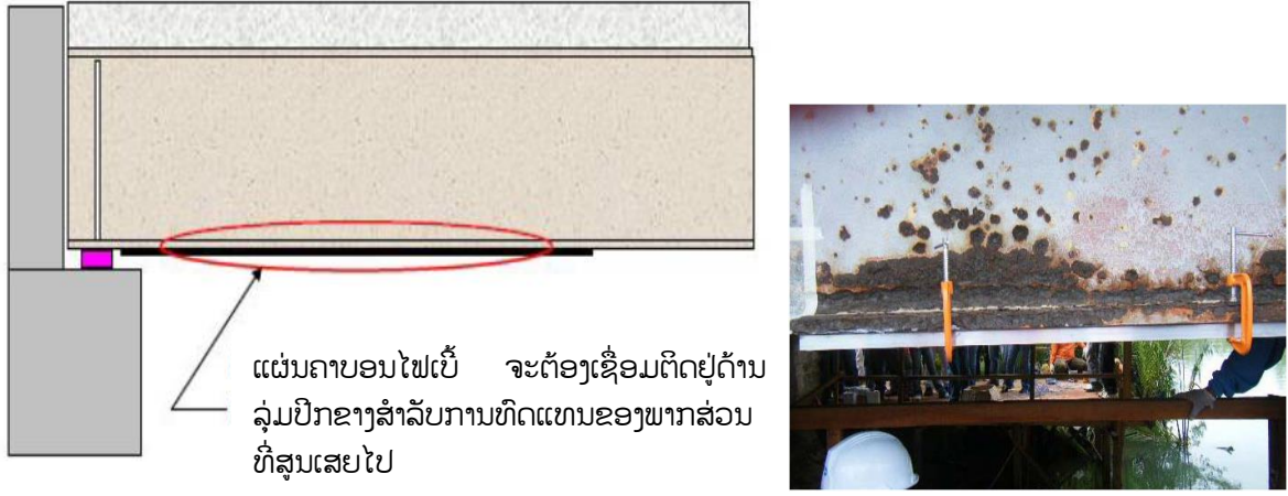
ຮູບທີ 6.2.2 ຕົວຢ່າງຂອງວິທີການເຊື່ອມຕິດແຜ່ນໄຟເບີ້ແບບຕໍ່ເນື່ອງ
